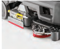
Cabezal lateral de fregado (opcional)
