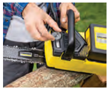
Visor del depósito de aceite
